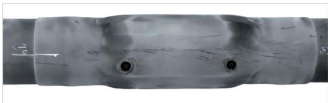
Typ spoje M 160 DPW po zkoušce 1500 pískoviště
