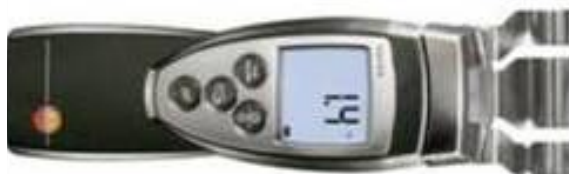
Obr. 4 Použitý přiložný vlhkoměr typ Testo 616
