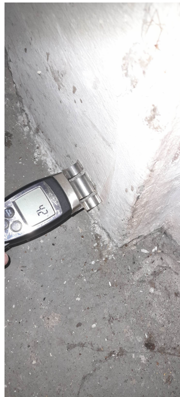
Obr. 83, 84, 85, 86, 87, 88 Vlhkost lokálně zvýšená až vysoká
