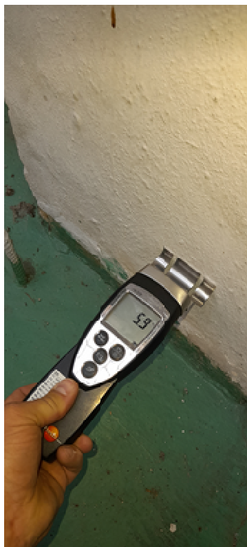
Obr. 83, 84, 85, 86, 87, 88 Vlhkost lokálně zvýšená až vysoká
