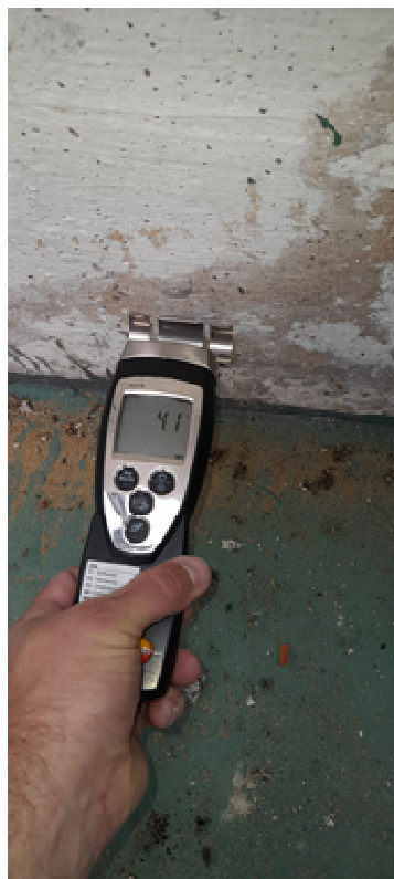
Obr. 83, 84, 85, 86, 87, 88 Vlhkost lokálně zvýšená až vysoká
