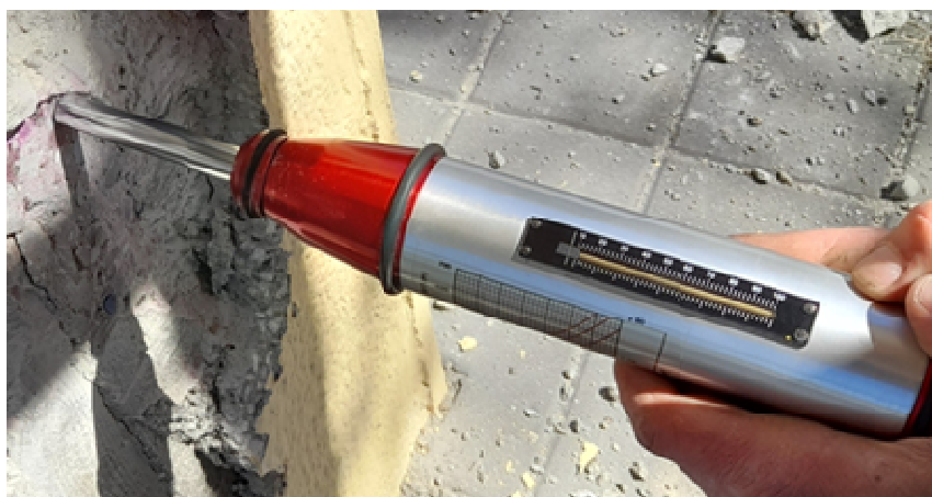
Obr. 3 Použité tvrdoměrné kladívko typ Schmidt N
